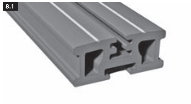
8.1 hohes UK-Profil 80 x 35 mm. Abstände der Unterstützungspunkte \leq 600 mm. (siehe 9.1)
