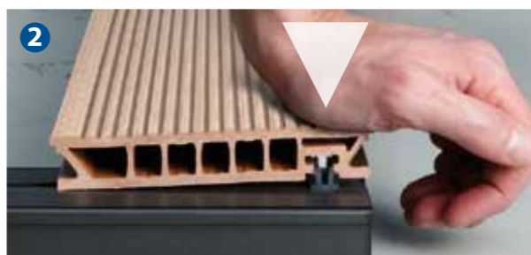
2 Anfangsclip auf der Unterkonstruktion festschrauben und erste Bodendiele einrasten.
